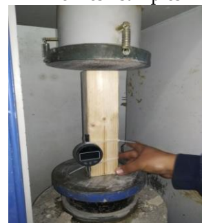
Fig. 7 : Compression test setup
